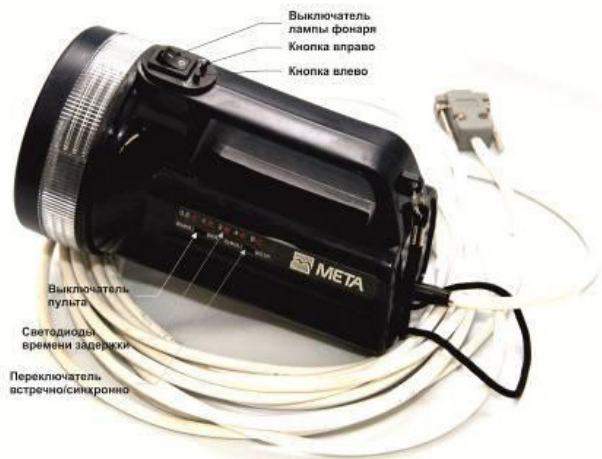
Рис. 2. Внешний вид пульта управления, совмещенного с фонарем
